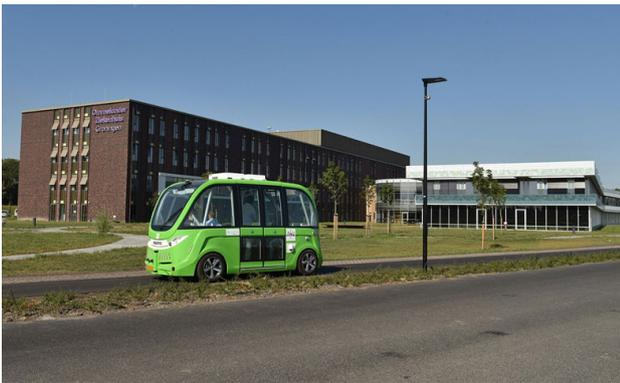
**15.** **Pilotage :** Nantes Métropole. **Lieu :** Nantes. **Principe :** un besoin d'amélioration de l'une des deux dessertes par transport en commun de son aéroport a été identifié. Le projet consiste en l'implantation simultanée d'une voie en site propre et d'un service de navettes autonomes à partir du terminus de la ligne de tramway T3. 3 ou 4 navettes seront en circulation sur un parcours en site propre. **Distance :** 2,4 km. Objectif de 950 passagers quotidiens.
